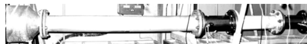
Рис. 7. Проливные испытания СВТУ-10М (Ду-150, класс точности 2) на горячеводной проливной установке УП «Минсккоммунтеплосеть»
